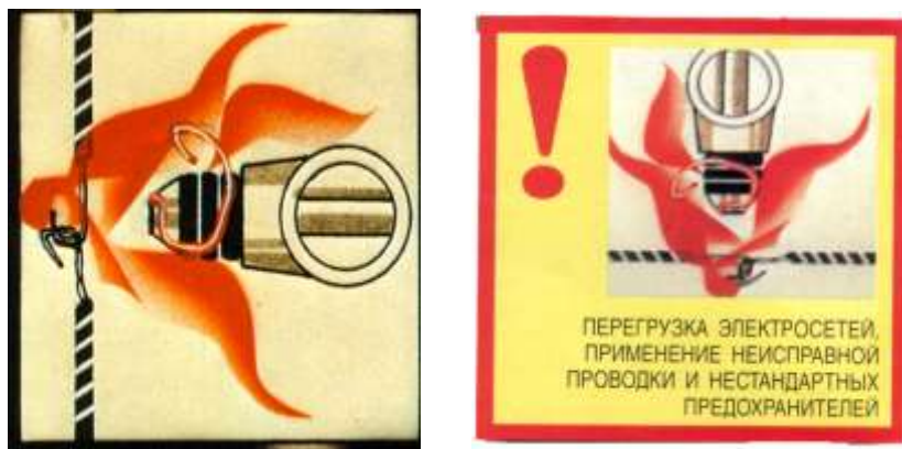
Неисправный предохранитель с «жучком»
